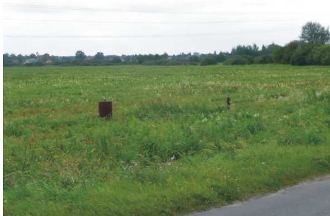
Fot. 7.7. Piezometry monitorujące wody podziemne w rejonie rynny brwinowskiej, M. Fic, 2007.
